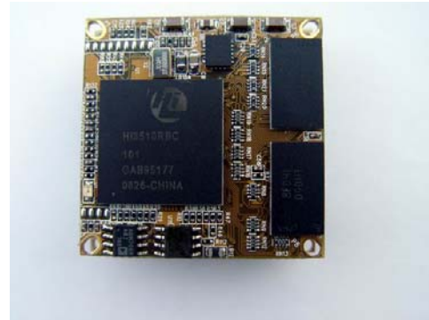
Built in mini web server(38x38mm)
